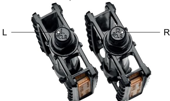
Abbildung 16: Beispiel Kennzeichnung von Pedalen
