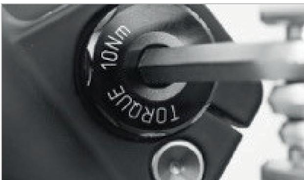
Abbildung 12: Achse anziehen
