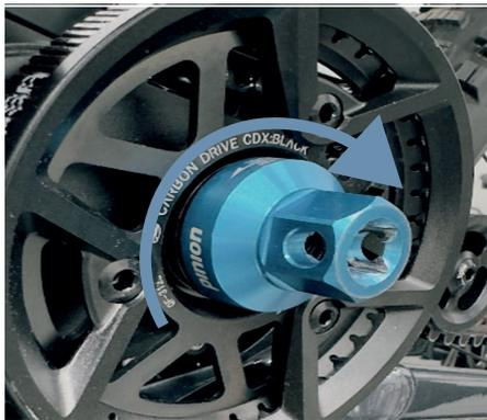
Abbildung 41: Kurbel-Klemmschraube lösen, rechts
