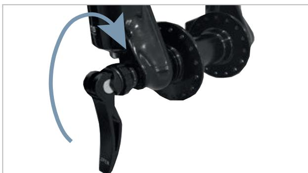
Abbildung 9: Hebel festziehen
