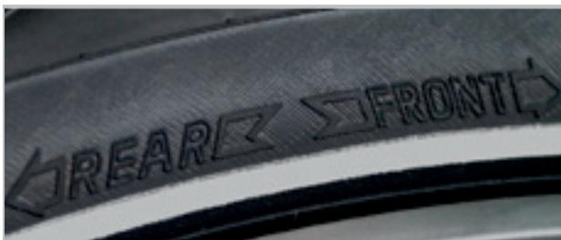
Abbildung 3: Laufrichtungspfeil auf MTB-Reifen
