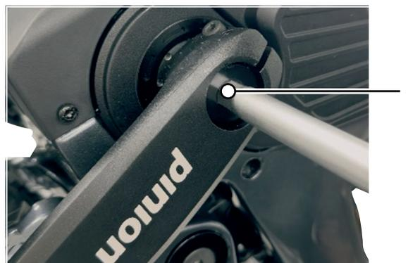
Abbildung 40: L-Pedal im linken Kurbelarm
