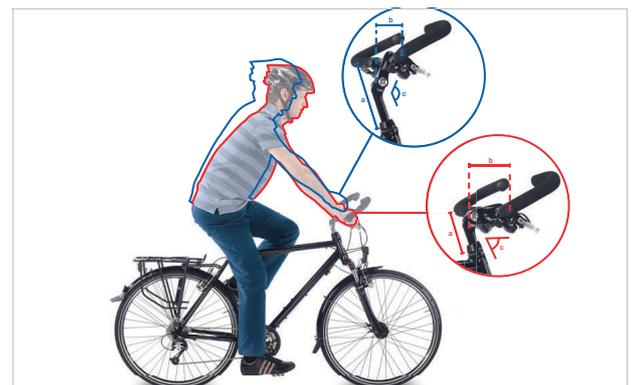
Abbildung 28: Citybike (blau) und Trekkingrad Position (rot) durch Winkeländerung
