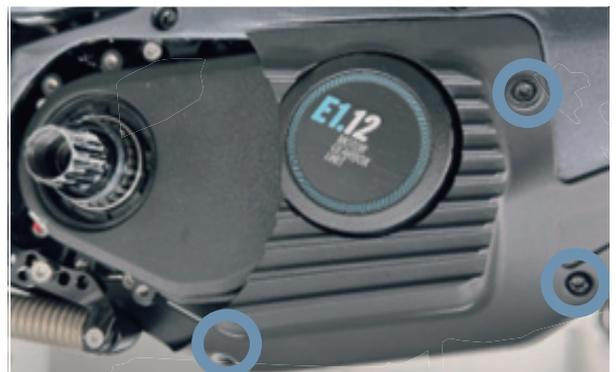
Abbildung 51: Kurbel-Klemmschraube lösen, links
