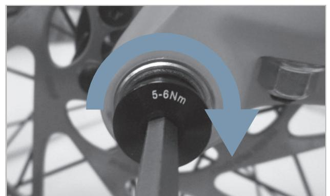
Abbildung 23: Sicherungsschraube anziehen
