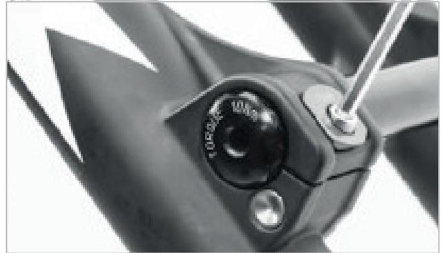
Abbildung 13: Sicherungsklemme anziehen
