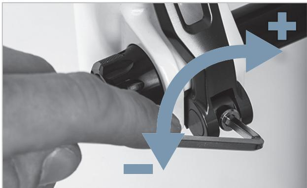
Abbildung 35: Spannkraft des Schnellspanners einstellen
