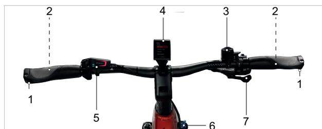
Abbildung 3: Lenker, Beispiel BOSCH LED Remote mit Kiox 300
