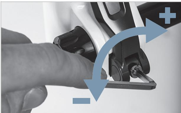
Abbildung 19: Spannkraft des Schnellspanners einstellen
