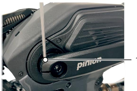
Abbildung 38: Kurbel-Klemmschraube lösen, links
