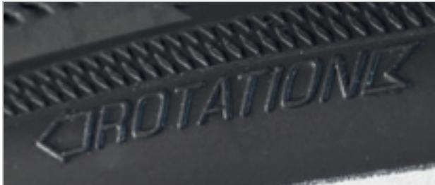
Abbildung 2: Laufrichtungspfeil
