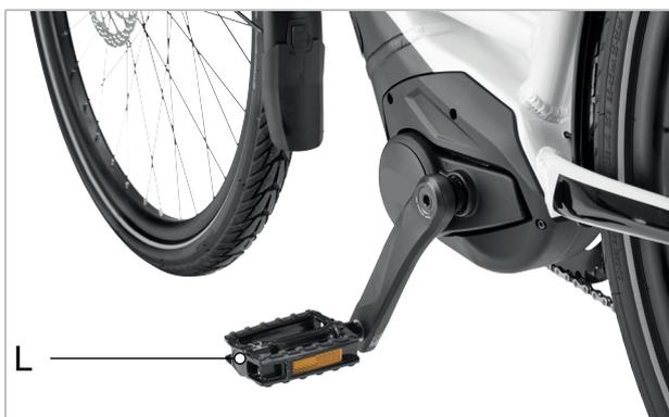
Abbildung 30: L-Pedal im linken Kurbelarm
