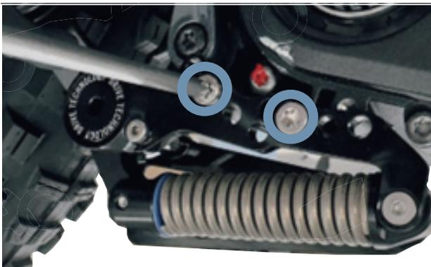
Abbildung 44: Riemenspanner-Schrauben lösen
