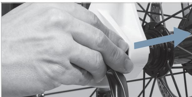
Abbildung 5: Schnellspanner in Pfeilrichtung einschieben
