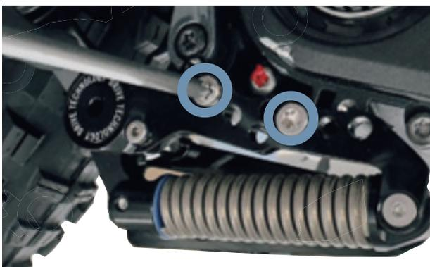
6 Riemenspanner-Schrauben festziehen
