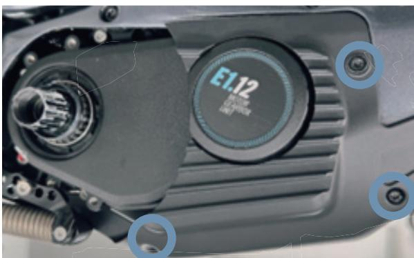
Abbildung 43: Kurbel-Klemmschraube lösen, links
