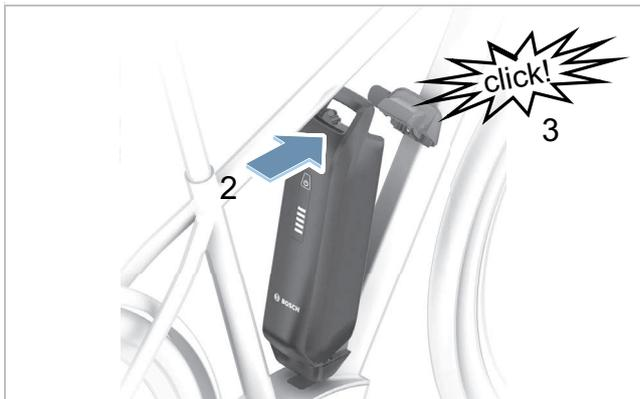
Abbildung 36: PowerPack Akku nach oben klappen
