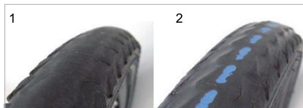
Abbildung 50: Reifen ohne Profil, der gewechselt werden kann (1) und Reifen mit durchscheinendem Pannenschutz (2), der gewechselt werden muss
