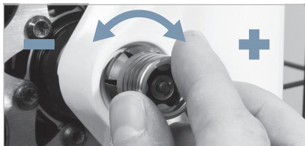
Abbildung 6: Spannung einstellen
