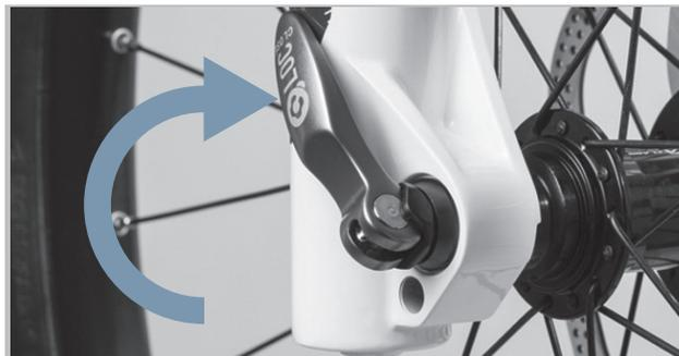
Abbildung 7: Schnellspanner schließen
