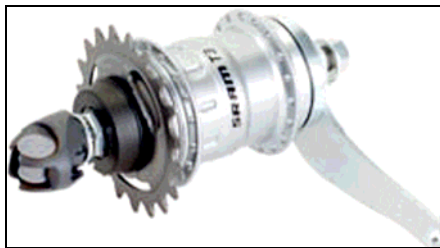
Bild 7 (SRAM T3: Klassische 3-Gang-Nabenschaltung)
